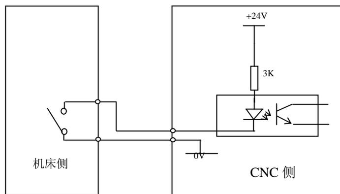
3.6.4 SP、ST 信号用机械触点式开关的常开触点；ESP 信号使用带自锁式的机械触点式开关的常闭触点。
