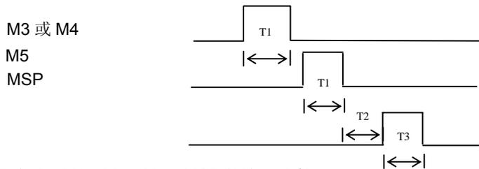
2) 电平控制方式时，M3、M4、M5、MSP 的输出时序：
