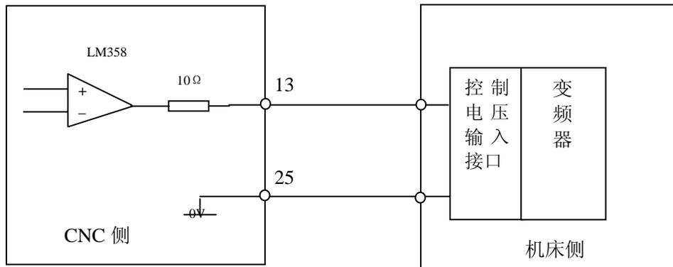
❗ 系统与变频器连接电缆须使用屏蔽电缆。
