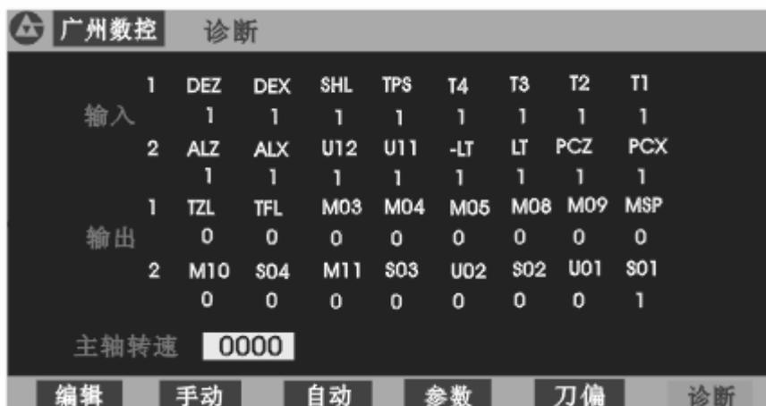
图 24 诊断方式显示画面
