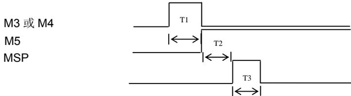
T1：脉冲控制方式时，M3、M4、M5 信号输出的持续时间，由 15 号参数设定；
