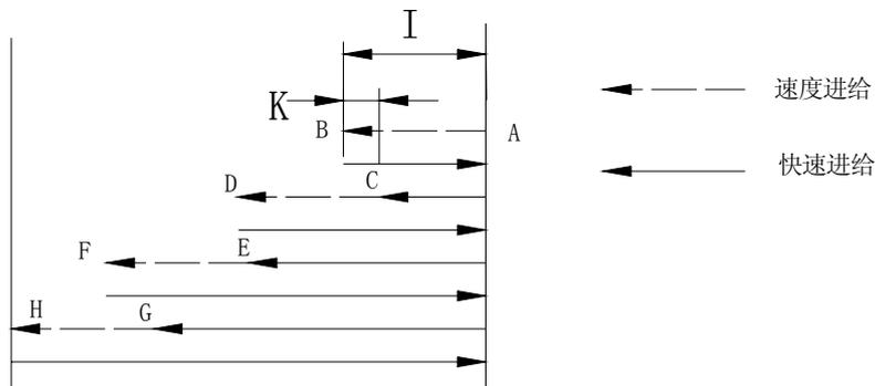
图 22 G74 循环—深孔钻循环 (R 非零)
