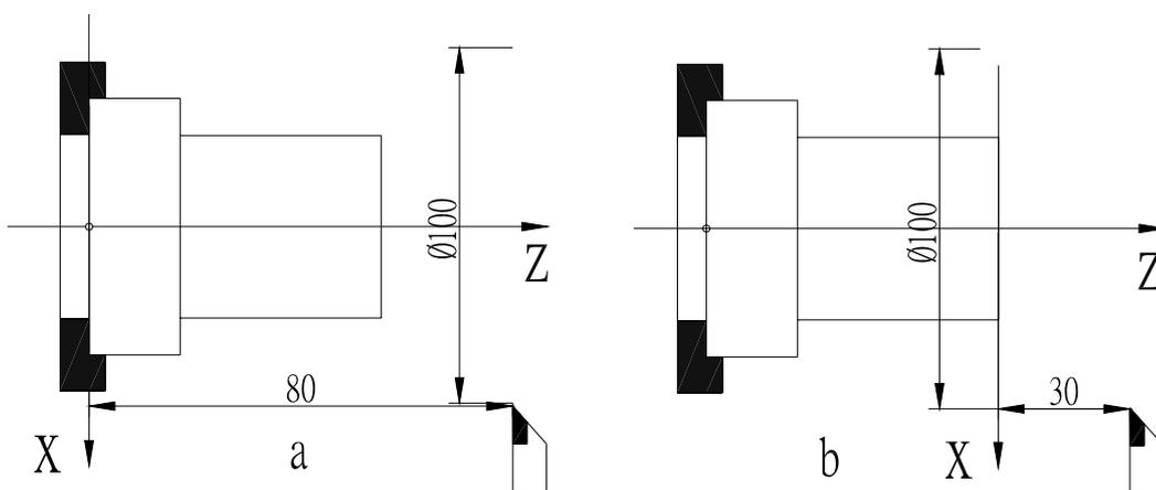
图 12 G50 工件坐标系设定
