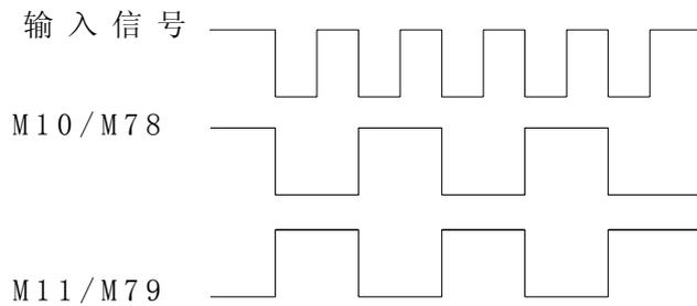
10) 冲控制方式时, 脚踏开关控制的 M10、M11、M78、M79 信号输出时序:
