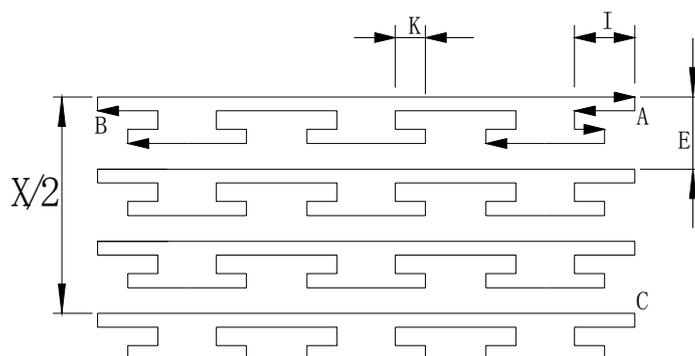
图 20 G74 端面深孔加工循环
