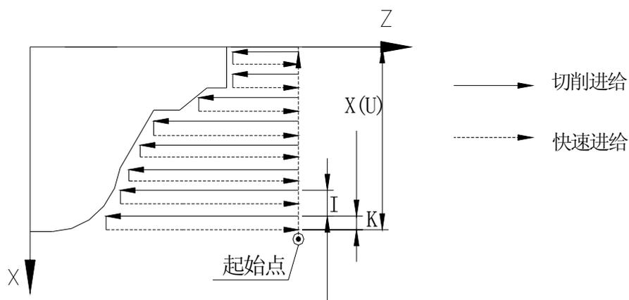
图 25 内外圆粗车复合循环
