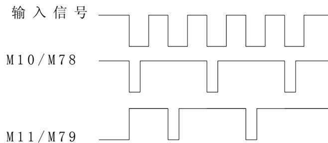
注: M10、M11、M78、M79 信号输出的持续时间, 由 P15 号参数设定;
