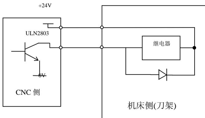
3.4.3.刀位信号 T1、T2、T3、T4 连接原理:
