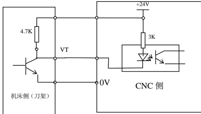
VT 的有效电平为低电平有效。即刀位到位时，对应刀位信号与 0V 之间导通。
