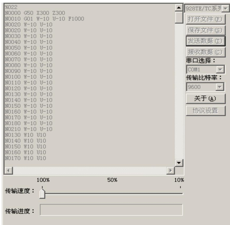
此时当 CNC 开启后即可自动进入发送状态，CNC 如果在 2 分钟内还没有开启，通信程序会弹出提示对话框告诉用户 CNC 未开启而重新恢复。
