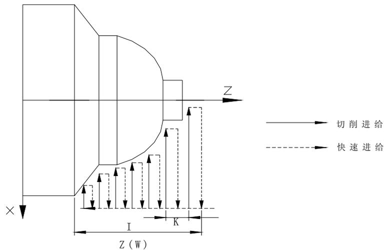
图 28 G72 端面粗车复合循环
