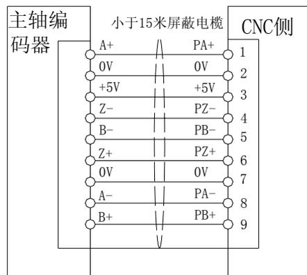
❗ 系统与主轴编码器连接电缆须使用屏蔽电缆，且屏蔽层必须与两端插座外壳相联。
