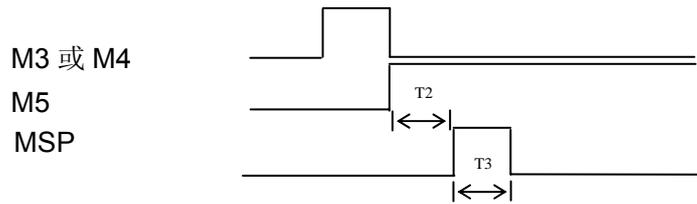
注: T1: 脉冲控制方式时, M3、M4、M5 信号输出的持续时间, 由 P15 号参数设定;
