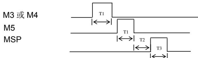
8) 平控制方式时, M3、M4、M5、MSP 的输出时序:
