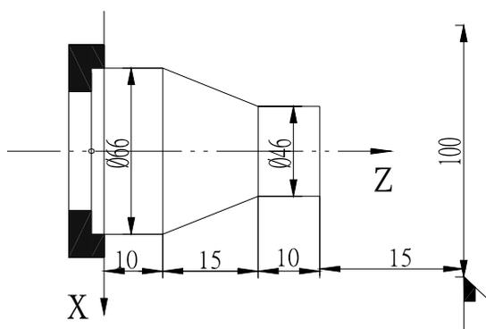
图 31 M98 M99 调用子程序切削示例
