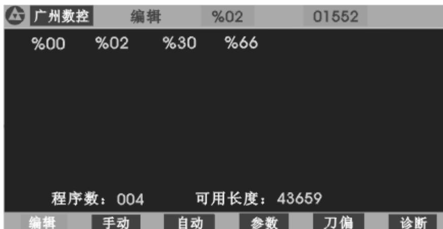
图 3 零件程序目录检索/零件程序建立，选择，删除等
