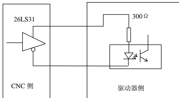
3.5.4 GSK928TE II 数控系统与混合式步进电机驱动器连接
